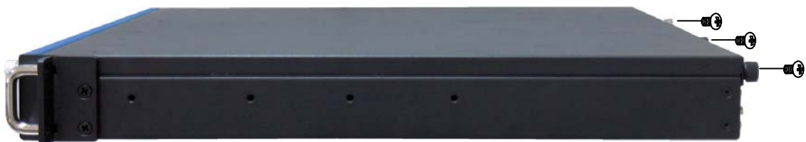
Abb. 15: Lösen der drei Befestigungsschrauben des Deckels an der Rückseite des KISS 1U Short Systems
