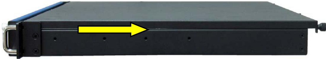
Abb. 16: Durch diese Bewegung werden die Fixierungsglaschen des Deckels, aus den Deckelhaltetaschen des Gehäuses herausgezogen.
