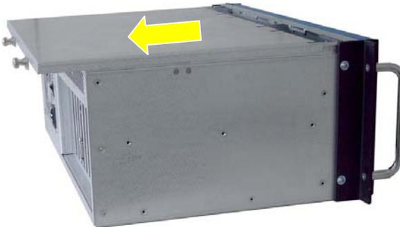
*Abb. 19a: Entfernen des Deckels*
