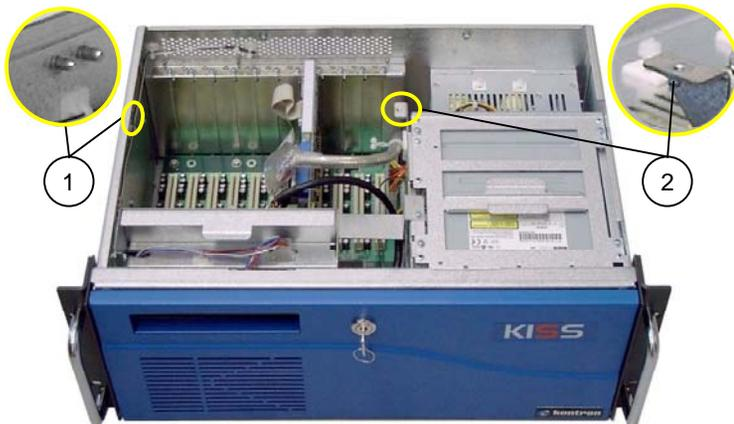
Abb. 21: Bolzen und Befestigungspunkt für Kartenniederhalter
