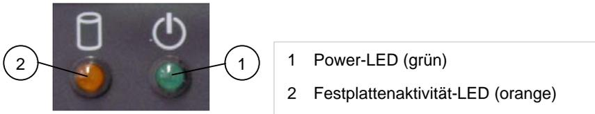
Abb. 12: Anzeigeelemente an der Frontseite
