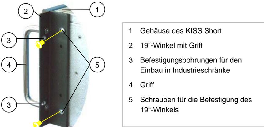
Abb. 8: 19°-Winkel mit Befestigungsschrauben
